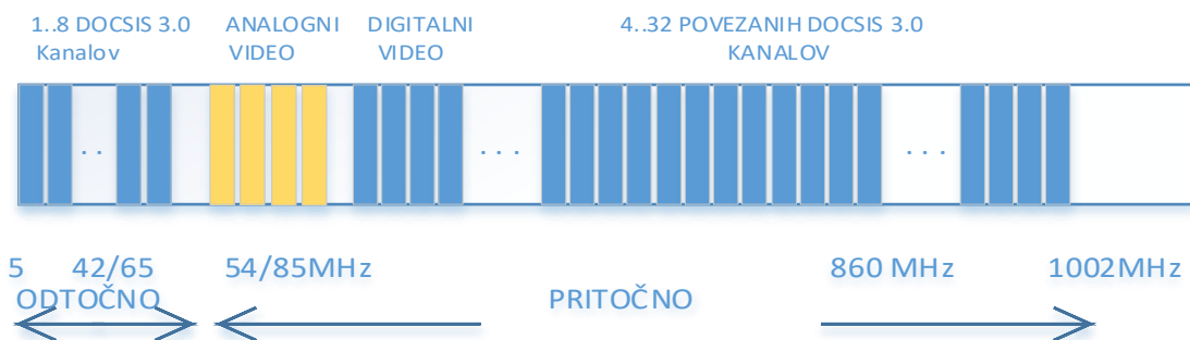
Slika 12: Razdelitev frekvenčnega spektra v kablenskem omrežju DOCSIS 3.0
